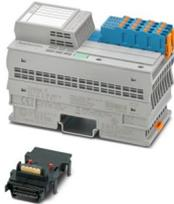
Axioline P, Modulo di ingresso analogico, Ingressi analogici attivi: 8 (HART), 4 mA ... 20 mA, tecnica di connessione: 2 conduttori, velocità di trasmissione nel bus locale: 100 MBit/s, Funzionalità HART, sicurezza intrinseca, grado di protezione: IP20, compresi modulo di base bus e connettori Axioline P
