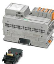
Axioline P, Modulo di ingresso analogico, Ingressi analogici attivi: 8 (HART), 4 mA ... 20 mA, tecnica di connessione: 2 conduttori, velocità di trasmissione nel bus locale: 100 MBit/s, Funzionalità HART, grado di protezione: IP20, compresi modulo di base bus e connettori Axioline P
