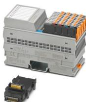
Axioline F, Modulo di ingresso digitale, Ingressi digitali: 16 (NAMUR), 8 V DC, tecnica di connessione: 2 conduttori, Variante per condizioni estreme:, velocità di trasmissione nel bus locale: 100 MBit/s, grado di protezione: IP20, incluso modulo di base bus e connettori Axioline F
