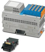
Axioline P, Modulo di ingresso digitale, Ingressi digitali: 16 (NAMUR), 8 V DC, tecnica di connessione: 2 conduttori, Funzionalità NAMUR, sicurezza intrinseca, velocità di trasmissione nel bus locale: 100 MBit/s, grado di protezione: IP20, compresi modulo di base bus e connettori Axioline P
