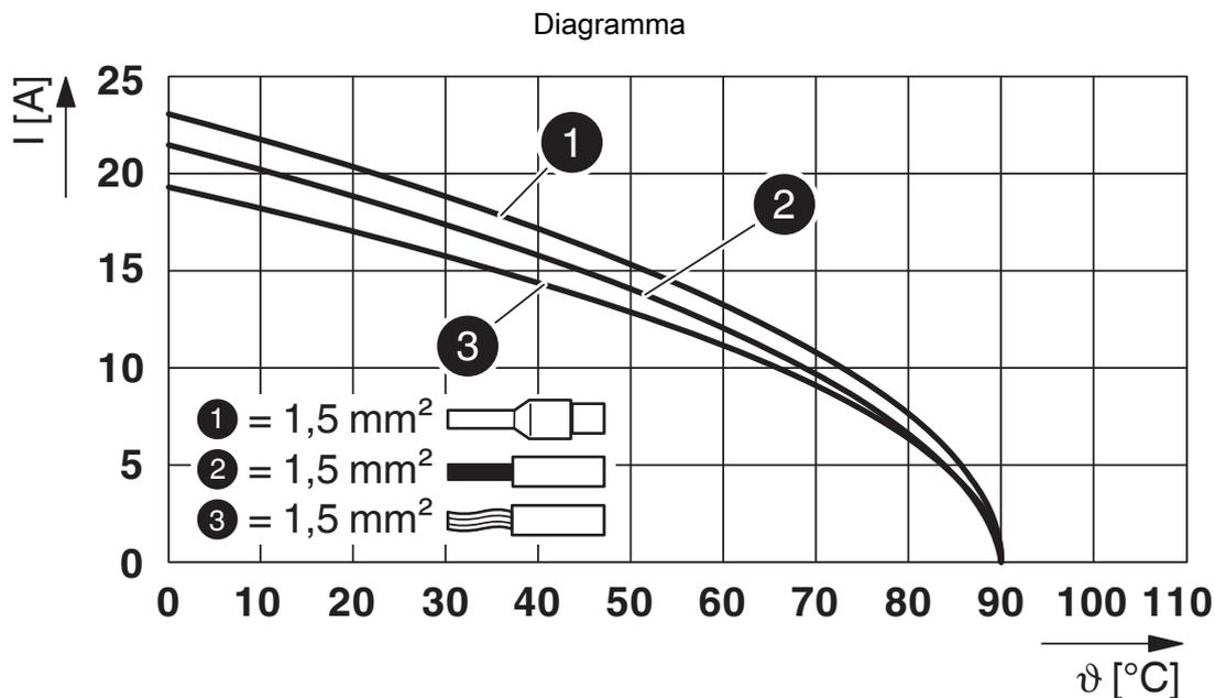
Diagramma di derating per 1,5 mm<sup>2</sup>
