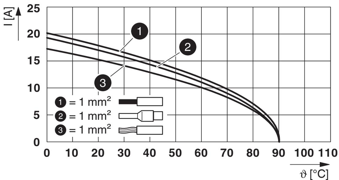
Diagramma di derating per 1,0 mm<sup>2</sup>
