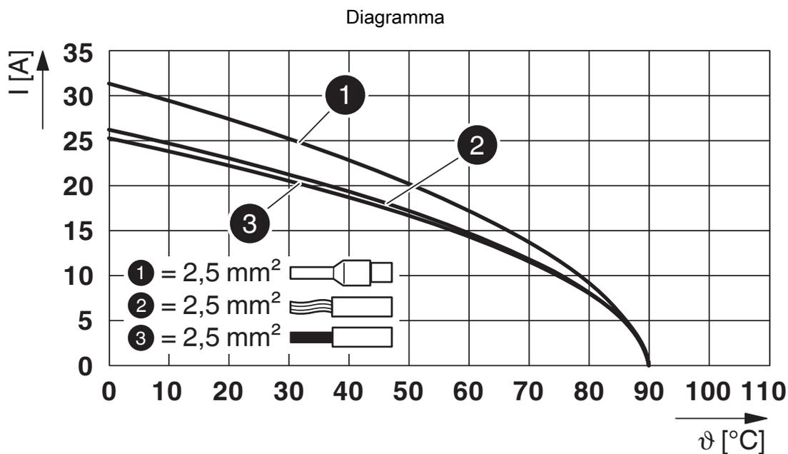
Diagramma di derating per 2,5 mm<sup>2</sup>
