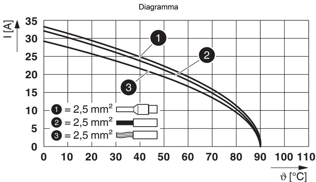
Diagramma di derating per 2,5 mm<sup>2</sup>
