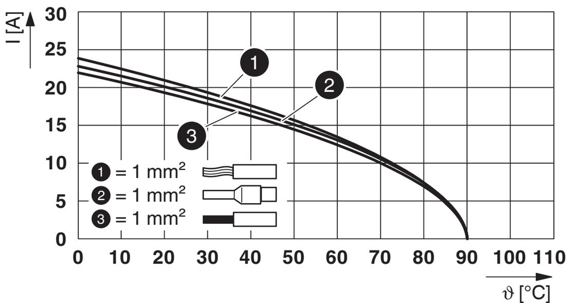
Diagramma di derating per 1,0 mm<sup>2</sup>
