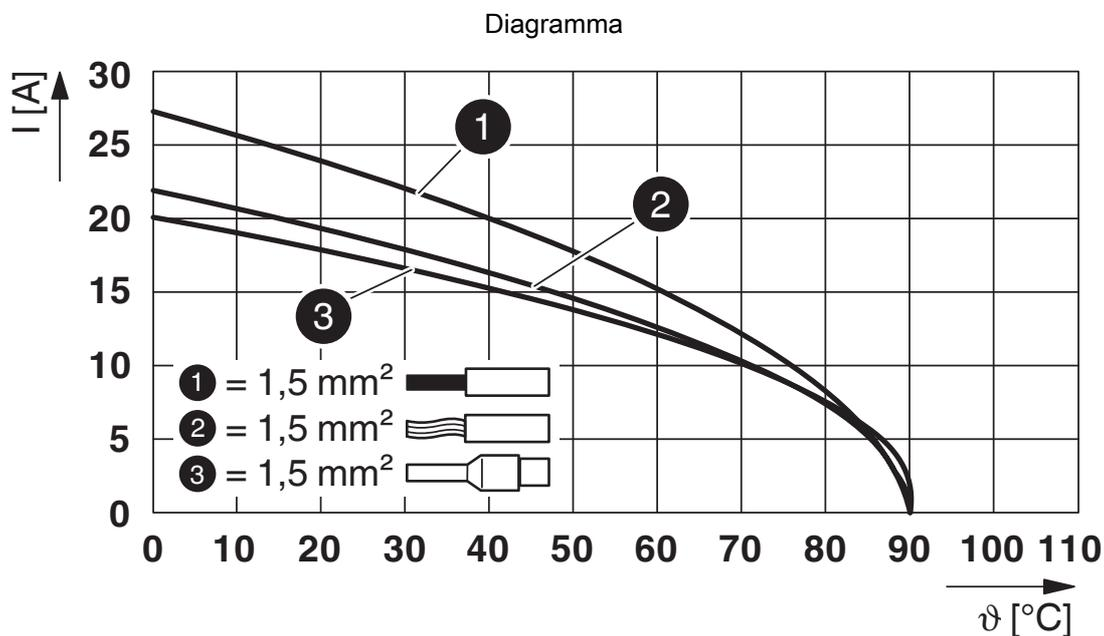
Diagramma di derating per 1,5 mm<sup>2</sup>
