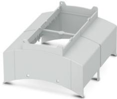
Custodia per guide DIN per l'impiego nei ripartitori di installazione a norma DIN 43880, parte superiore custodia modulare, larghezza: 107,6 mm, altezza: 89,7 mm, profondità: 54,85 mm, colore: grigio chiaro (simili RAL 7035)
