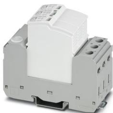
Scaricatore di sovratensione di dispersione ad innesto per sistemi a tensione continua isolati e con messa a terra a 2 poli, per correnti lineari fino a 380 V DC, per montaggio su guida DIN, elemento base a 3 poli con contatto da remoto, tre elementi di protezione estraibili controllati termicamente, messaggio di stato su ogni connettore.
