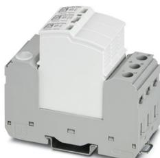
Scaricatore di sovratensione di dispersione ad innesto per sistemi a tensione continua isolati e con messa a terra a 2 poli, per correnti lineari fino a 48 V DC, per montaggio su guida DIN, elemento base a 3 poli con contatto da remoto, tre elementi di protezione estraibili controllati termicamente, messaggio di stato su ogni connettore.
