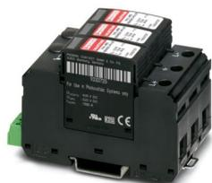
Scaricatore di sovratensione per sistemi fotovoltaici a tensione continua a 2 poli isolati e collegati a terra 1500 V DC, per montaggio su guida DIN, elemento di base a 3 poli con contatto di segnalazione remota, tre elementi di protezione a innesto monitorati termicamente, segnalazione di stato su ogni connettore.
