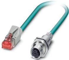
Cavo Ethernet confezionato, CAT5e, schermato, 2 coppie, AWG26 flessibile (7 fili), RAL 5021 (azzurro mare), connettore femmina da incasso M12, montaggio posteriore/a vite SPEEDCON su connettore maschio RJ45/IP20, Line, lunghezza 2 m
