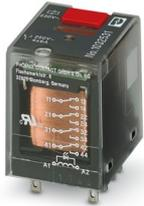
Relè industriale a innesto con contatti di potenza, 4 contatti di scambio, tasto di prova, LED di stato, segnalazione meccanica di stato, tensione d'ingresso: 230 V DC
