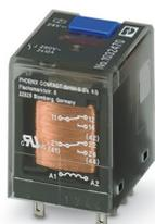
Relè industriale a innesto con contatti di potenza, 2 contatti di scambio, tasto di prova, segnalazione meccanica di stato, polarità A1+, A2-, tensione d'ingresso: 24 V DC
