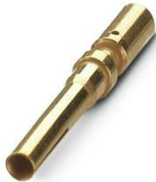
Contatto a crimpare, diametro contatti: 1,5 mm, tornito, Femmina, materiale contatti: CuZn, superficie contatti: Ni/Au, sezione di connessione: 1,5 mm<sup>2</sup> ... 1,5 mm<sup>2</sup>, AWG 14, per la connessione PE o FE
