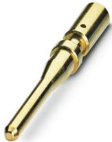
Contatto a crimpare, diametro contatti: 1,5 mm, tornito, Spina, materiale contatti: CuZn, superficie contatti: Ni/Au, sezione di connessione: 1,5 mm<sup>2</sup> ... 1,5 mm<sup>2</sup>, AWG 14, per la connessione PE o FE
