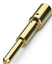
Contatto a crimpare, diametro contatti: 1,5 mm, tornito, Spina, materiale contatti: CuZn, superficie contatti: Ni/Au, sezione di connessione: 1,5 mm<sup>2</sup> ... 1,5 mm<sup>2</sup>, AWG 14 ... 14
