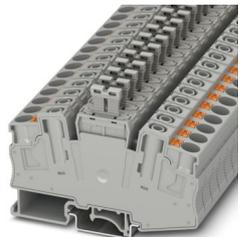
Morsetto sezionatore, tensione nominale: 1000 V, corrente nominale: 32 A, tipo di connessione: Connessione Push-in, Sezione di dimensionamento: 6 mm<sup>2</sup>, sezione: 0,5 mm<sup>2</sup> - 10 mm<sup>2</sup>, montaggio: NS 35/7,5, NS 35/15, NS 32, colore: grigio
