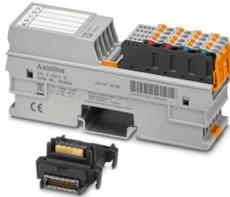
Axioline F, Modulo funzionale, Ingressi conteggio: 2, Ingressi digitali: 6, 24 V DC, Uscite digitali: 4, 24 V DC, velocità di trasmissione nel bus locale: 100 MBit/s, grado di protezione: IP20, incluso modulo di base bus e connettori Axioline F
