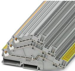
Morsetto a più piani, tensione nominale: 500 V, corrente nominale: 15 A, tipo di connessione: Push-in / attacco connettore, 1. piano, Sezione di dimensionamento: 1,5 mm<sup>2</sup>, sezione: 0,14 mm<sup>2</sup> - 1,5 mm<sup>2</sup>, tipo di montaggio: NS 35/7,5, NS 35/15, colore: grigio
