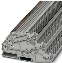
Morsetto a più piani, Corrente e tensione sono determinate dalla spina impiegata., con ripartitore di potenziale, tensione nominale: 500 V, corrente nominale: 15 A, tipo di connessione: Push-in / attacco connettore, 1. piano, Sezione di dimensionamento: 1,5 mm<sup>2</sup>, sezione: 0,14 mm<sup>2</sup> - 1,5 mm<sup>2</sup>, tipo di montaggio: NS 35/7,5, colore: grigio
