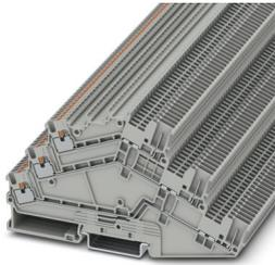
Morsetto a più piani, Corrente e tensione sono determinate dalla spina impiegata., tensione nominale: 500 V, corrente nominale: 15 A, tipo di connessione: Push-in / attacco connettore, 1. piano, Sezione di dimensionamento: 1,5 mm<sup>2</sup>, sezione: 0,14 mm<sup>2</sup> - 1,5 mm<sup>2</sup>, tipo di montaggio: NS 35/7,5, colore: grigio
