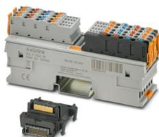
Axioline F, Master IO-Link, porte IO-Link Class A: 8, tipo di connessione: Connessione Push-in, tecnica di connessione: 3 conduttori, velocità di trasmissione nel bus locale: 100 MBit/s, grado di protezione: IP20, incluso modulo di base bus e connettori Axioline F
