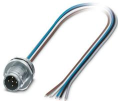
Connettore per apparecchi anteriore, Universale, 5-poli, Connettore, diritto, M12-Bloccaggio esterno Push-Pull, codifica: A, su estremità conduttore libera, Montaggio anteriore, M16 x 1,5, Fili singoli, lunghezza cavo: 0,5 m, 0,34 mm<sup>2</sup>, Filo in TPE, saldato, L'articolo è senza piombo secondo la direttiva RoHS II senza eccezione 6c (Pb < 0,1 %)
