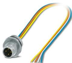
Connettore per apparecchi anteriore, PROFINET CAT5 (IEC 11801:2002), 4-poli, Connettore, diritto, M12-Bloccaggio esterno Push-Pull, codifica: D, su estremità conduttore libera, Montaggio anteriore, M16 x 1,5, Fili singoli, lunghezza cavo: 0,5 m, 0,34 mm<sup>2</sup>, Filo in TPE, saldato, L'articolo è senza piombo secondo la direttiva RoHS II senza eccezione 6c (Pb < 0,1 %)
