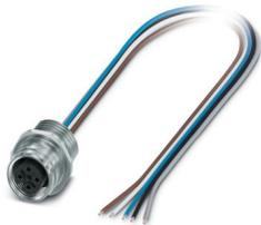
Connettore per apparecchi anteriore, Universale, 5-poli, Femmina, diritto, M12-Bloccaggio esterno Push-Pull, codifica: A, su estremità conduttore libera, Montaggio anteriore, M16 x 1,5, Fili singoli, lunghezza cavo: 0,5 m, 0,34 mm<sup>2</sup>, Filo in TPE, saldato
