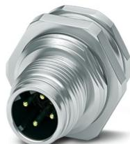
Connettore per apparecchi posteriore, 4-poli, Connettore, diritto, M12-Bloccaggio esterno Push-Pull, codifica: D, Montaggio posteriore, M16 x 1,5, Saldatura a onde, L'articolo è senza piombo secondo la direttiva RoHS II senza eccezione 6c (Pb < 0,1 %)
