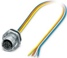
Connettore per apparecchi posteriore, PROFINET CAT5 (IEC 11801:2002), 4-poli, Femmina, diritto, M12-Bloccaggio esterno Push-Pull, codifica: D, su estremità conduttore libera, Montaggio posteriore, M16 x 1,5, Fili singoli, lunghezza cavo: 0,5 m, 0,34 mm<sup>2</sup>, Filo in TPE, saldato, Questo articolo è in continuo adattamento. Alternativa senza piombo secondo RoHS II senza eccezione 6c (Pb < 0,1%) possibile in anticipo su richiesta.
