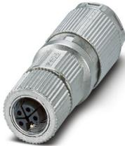
Connettore Power, Potenza, 4-poli, schermata, Femmina diritto M12, codifica: L, Connessione a crimpare, materiale zigrinato: Pressofuso di zinco, stagnato, diametro esterno conduttore 8 mm .
