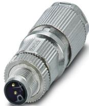
Connettore Power, Potenza, 4-poli, schermata, Maschio diritto M12, codifica: L, Connessione a crimpare, materiale zigrinato: Pressofuso di zinco, stagnato, diametro esterno conduttore 8 mm .
