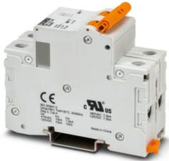
Interruttore TM (termomagnetico), 2-poli, utilizzo: Supplementary Protection (UL 1077), per la protezione dal sovraccarico con corrente di cortocircuito fino a 7,5 kA, curva caratteristica di intervento: C, tipo di montaggio: NS 35 ..., corrente nominale: 4 A
