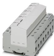
Scaricatore di corrente atmosferica ad innesto, secondo tipo 1/classe I/B, per reti di alimentazione trifase con PE e N separati (L1, L2, L3, PE, N).
