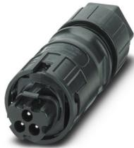
Connettore, Serie di prodotti: PRC 35, tipo: Sbloccaggio con un utensile o a mano (vedere Accessori), colore: nero, numero poli: 3, sezione del conduttore min.: 1,5 mm<sup>2</sup>, sezione del conduttore max.: 6 mm<sup>2</sup>, tensione di dimensionamento: 690 V AC, corrente nominale: 35 A, Tipo di connessione: Connessione a vite, Tipo di connessione del contatto: Spina, diametro cavo min.: 8 mm, diametro cavo max.: 21 mm, Protezione antinfortunistica garantita
