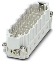
Inserto contatti, numero poli: 46+PE, dimensioni: B24, contatti di potenza: 46, contatti di comando: 0, numero di connessioni per polo: 1, Spina, Connessione Push-in, 500 V, 16 A, 0,5 mm<sup>2</sup> ... 2,5 mm<sup>2</sup>, applicazione: Potenza
