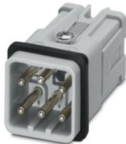
Inserto contatti, numero poli: 5+PE, dimensioni: D7, contatti di potenza: 5, numero di connessioni per polo: 1, Spina, Connessione Push-in, 230 V, 16 A, 0,5 mm<sup>2</sup> ... 2,5 mm<sup>2</sup>, applicazione: Potenza
