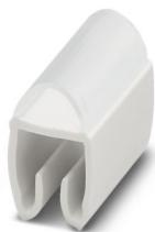
Portacartellini per conduttori, trasparente, in bianco, diametro cavi: 2,8 ... 4,4 mm, tipo di montaggio: agganciare, altezza del campo di testo: 4 mm, larghezza del campo di testo: 10 mm
