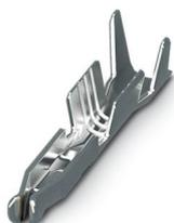
Contatto a crimpare, corrente nominale: 6 A, tipo di connessione del contatto: Femmina, tipo di connessione: Connessione a crimpare, superficie contatti: Oro, tipo di confezione: Prodotti sfusi
