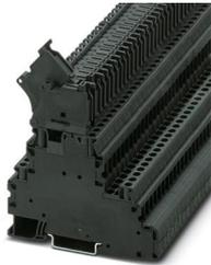
Morsetto portafusibili, con diodo 1N4007, tipo di fusibile: Vetro / ceramica / ..., tipo fusibile: G / 5 x 20, tensione nominale: 500 V, corrente nominale: 28 A, tipo di connessione: Connessione a vite, Sezione di dimensionamento: 4 mm<sup>2</sup>, sezione: 0,14 mm<sup>2</sup>- 6 mm<sup>2</sup>, tipo di connessione: Connessione a vite, Sezione di dimensionamento: 1 mm<sup>2</sup>, sezione: 0,14 mm<sup>2</sup>- 6 mm<sup>2</sup>, tipo di montaggio: NS 35/7,5, NS 35/15, colore: nero
