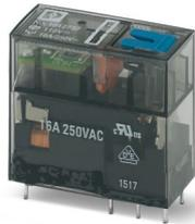
Relè in miniatura ad innesto, con contatto di potenza, 1 contatto di scambio, tasto di prova, segnalazione meccanica di stato, LED di stato, diodo di smorzamento, polarità A1+, A2-, tensione d'ingresso 110 V DC
