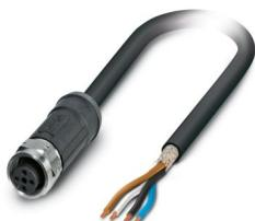
Cavo sensore/attuatore, 4-poli, PE-X/PE-X senza alogenati, grigio-nero RAL 7021, schermata, estremità conduttore libera, su Connettore femmina diritto M12, codifica: A, lunghezza cavo: 40 m, per applicazioni outdoor, con zigrinatura in acciaio inox
