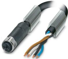
Cavo di alimentazione, 4-poli, PUR senza alogenati, grigio-nero RAL 7021, estremità conduttore libera, su Connettore femmina diritto M12, codifica: T, lunghezza cavo: 15 m, per corrente continua fino a 12 A / 63 V
