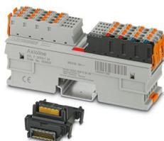
Axioline F, Modulo di uscita digitale, Uscite digitali: 32, 24 V DC, 500 mA, tecnica di connessione: 1 conduttore, velocità di trasmissione nel bus locale: 100 MBit/s, grado di protezione: IP20, incluso modulo di base bus e connettori Axioline F
