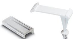
Portacartellino per moduli Phoenix, per la siglatura di moduli e circuiti stampati, diametro fori da 3,9 fino a 4,1 mm di diametro, spessore parete o scheda 1,5 – 2,0 mm, siglatura con nastro ESL, EST, oppure ES/LP-BW-GB, dimensioni campo di siglatura: 29 x 8 mm
