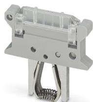
Spina di sezionamento, per utilizzare il morsetto portafusibili base come morsetto sezionatore a spina, profondità: 42,7 mm, larghezza: 7,8 mm, altezza: 46 mm
