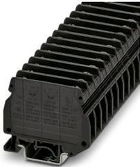
Morsetto portafusibili, senza spina portafusibili, tensione nominale: 500 V, corrente nominale: 10 A, 1. piano, tipo di connessione: Connessione a vite, Sezione di dimensionamento: 1,5 mm<sup>2</sup>, sezione: 0,5 mm<sup>2</sup> - 16 mm<sup>2</sup>, montaggio: NS 35/7,5, NS 35/15, NS 32, colore: nero
