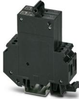
Interruttore di protezione magnetotermico, a 2 poli, semi-ritardato, con 1 contatto in chiusura e 1 contatto in apertura, con piedino universale per il montaggio su NS 32 oppure NS 35
