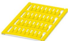
Siglatura di conduttori, Scheda, giallo, in bianco, siglabile con: BLUEMARK E.CARD, BLUEMARK ID COLOR, BLUEMARK ID, BLUEMARK CLED, THERMOMARK PRIME 2.0, THERMOMARK PRIME, THERMOMARK CARD 2.0, THERMOMARK CARD, TOPMARK NEO, TOPMARK LASER, diametro cavi: 2 ... 2,9 mm, tipo di montaggio: agganciare, Numero dei cartellini singoli: 32, altezza del campo di testo: 4 mm, larghezza del campo di testo: 18 mm
