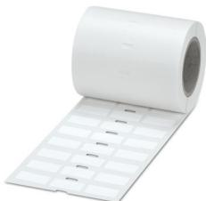
Etichetta, staccabile, Rotolo, bianco, in bianco, siglabile con: THERMOMARK E.300 (D)/600 (D), THERMOMARK ROLL 2.0, THERMOMARK ROLL, THERMOMARK ROLL X1, THERMOMARK ROLLMASTER 300/600, THERMOMARK X1.2, tipo di montaggio: colla, Numero dei cartellini singoli: 2500, altezza del campo di testo: 12,7 mm, larghezza del campo di testo: 25,4 mm
