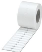
Etichetta, staccabile, Rotolo, bianco, in bianco, siglabile con: THERMOMARK E.300 (D)/600 (D), THERMOMARK ROLL 2.0, THERMOMARK ROLL, THERMOMARK ROLL X1, THERMOMARK ROLLMASTER 300/600, THERMOMARK X1.2, tipo di montaggio: colla, Numero dei cartellini singoli: 4000, altezza del campo di testo: 8 mm, larghezza del campo di testo: 25 mm
