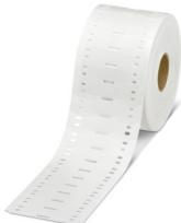
Targhetta per cavi, Rotolo, bianco, in bianco, siglabile con: THERMOMARK E.300 (D)/600 (D), THERMOMARK ROLL 2.0, THERMOMARK ROLL, THERMOMARK ROLL X1, THERMOMARK ROLLMMASTER 300/600, THERMOMARK X1.2, tipo di montaggio: Montaggio a fascette, diametro cavo:  $\geq 6$  mm, Numero dei cartellini singoli: 1000, altezza del campo di testo: 15 mm, larghezza del campo di testo: 55 mm
