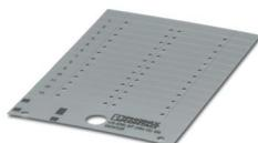
Cartellino da incollare, da fissare con viti o rivetti, Scheda, argento, in bianco, siglabile con: BLUEMARK ID COLOR, BLUEMARK ID, THERMOMARK PRIME, THERMOMARK CARD 2.0, THERMOMARK CARD, THERMOMARK PRIME 2.0, tipo di montaggio: Incollaggio, fissaggio con viti, rivetti, colla, Numero dei cartellini singoli: 26, altezza del campo di testo: 10 mm, larghezza del campo di testo: 28 mm
